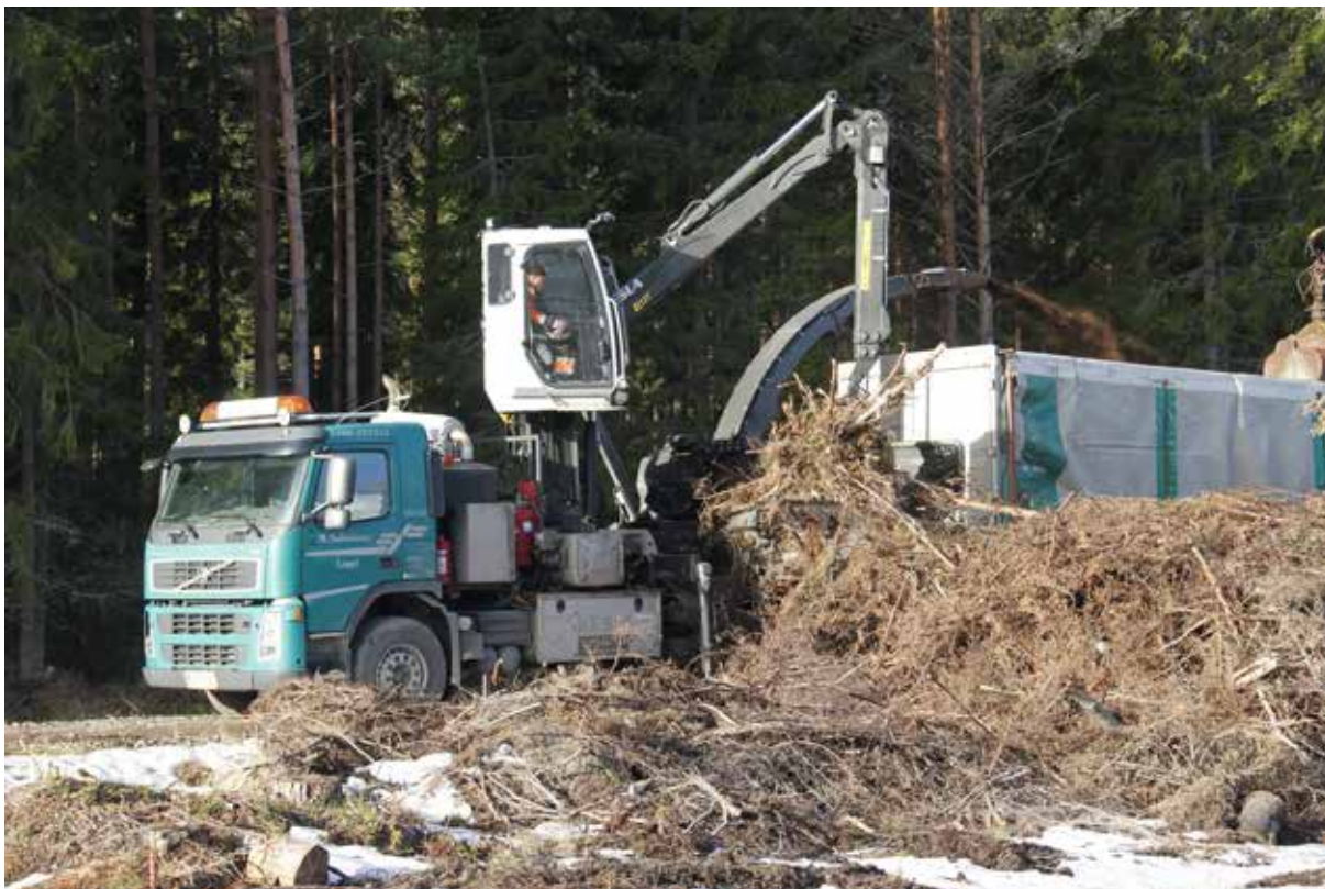
10. fotoattēls. Uzglabāšana un šķeldošana notiek augšgala krautuvē pie ceļa, un šķeldas pēc tam tieši vai caur termināli tiek nogādātas klientam (Foto: Lars Eliasson)
