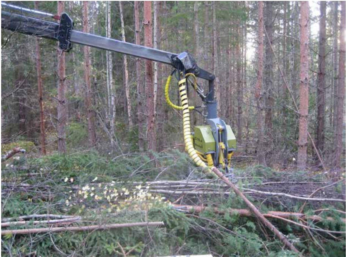
8. fotoattēls. Mazo dimensiju koku mežizstrādei, lietojot harvesteru galvas, tiek izmantoti trīs tehniskie pārzāģēšanas risinājumi (Foto: Maria Iwarsson Wide)
