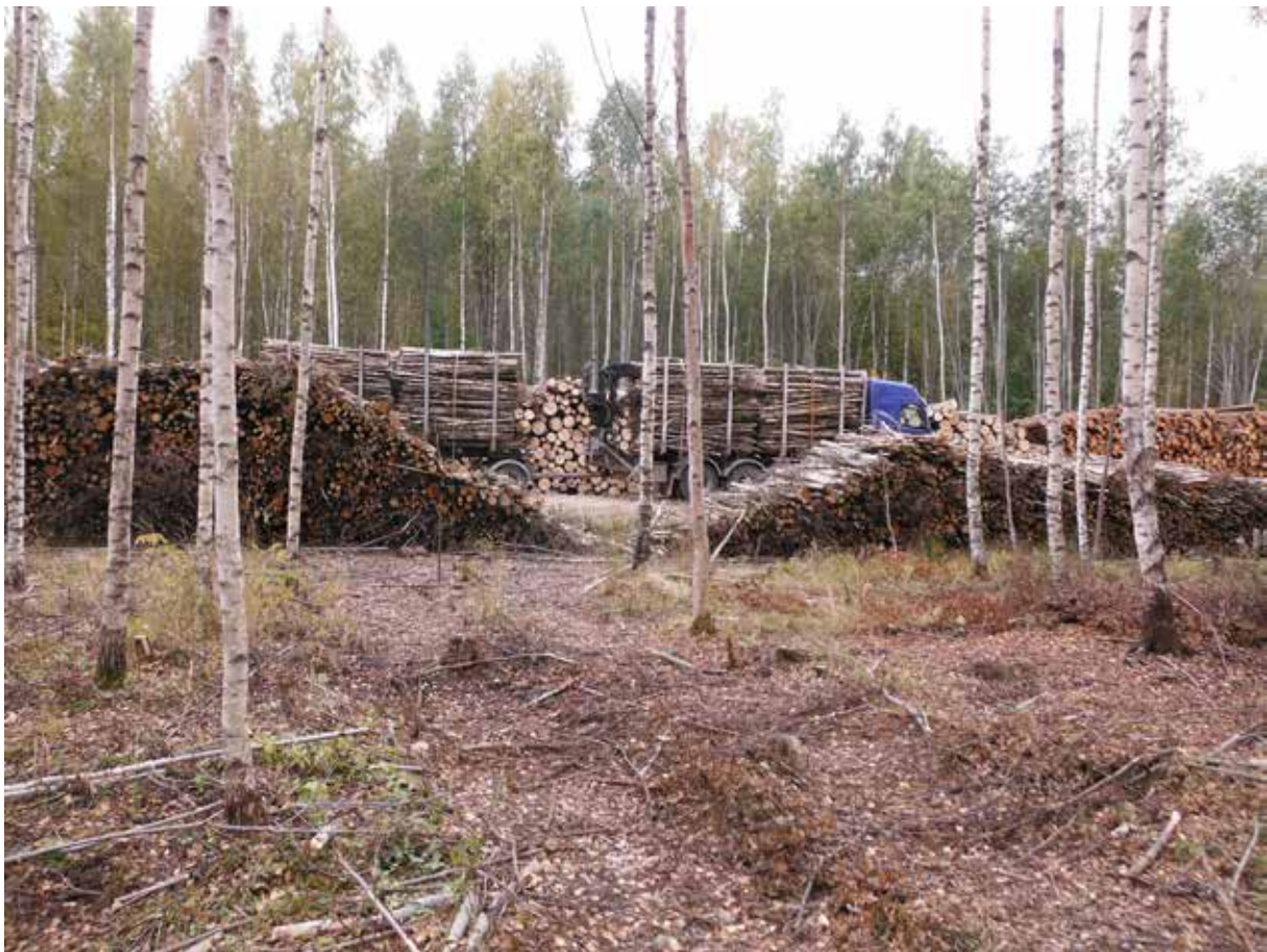
17. fotoattēls. Ja materiāls ir labi atzarots, to var izvest parastajās kokvedēju automašīnās. Koksnes biomasa, kas saražota no mazo dimensiju kokiem bērza audžu krājas kopšanas cirtes laikā, tiek piegādāta granulu rūpnīcai Jēkabpilī (Foto: Andis Lazdiņš)
