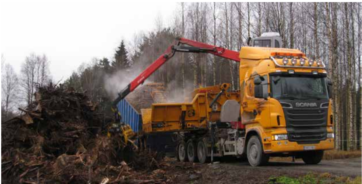
42. fotoattēls. Celmus pirms nogādāšanas siltumenerģijas ražotnēs sasmalcina uz vietas (Foto: Juha Laitila)
