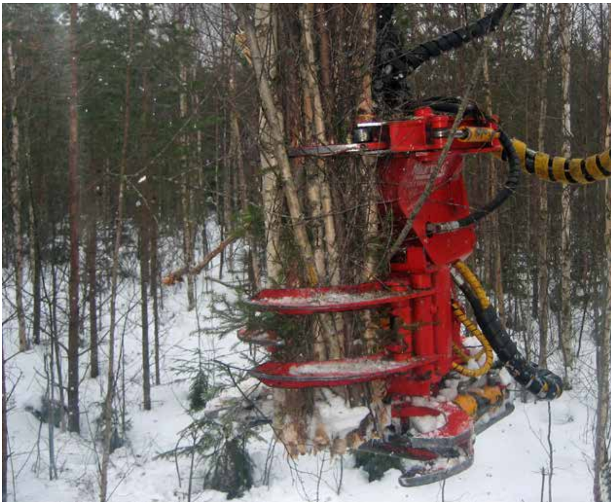
9. fotoattēls. Harvesteru galvas, kas ir īpaši pielāgotas vairāku mazo dimensiju koku vienlaicīgai apstrādei, nodrošina lielāku koku mežizstrādes efektivitāti (Foto: Maria Iwarsson Wide)
